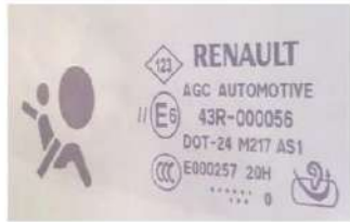
Serigrafía de un vidrio para automóvil homologado según Reglamento 43 de la UE.
